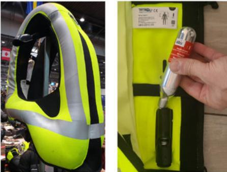
Abb. 32: ausgelöste Airbag-Weste und Gaskartusche
